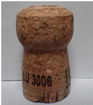
Abbildung 16: Schaumweinkorken im oberen Teil Agglomerat im unteren 2 Korkscheiben verklebt
