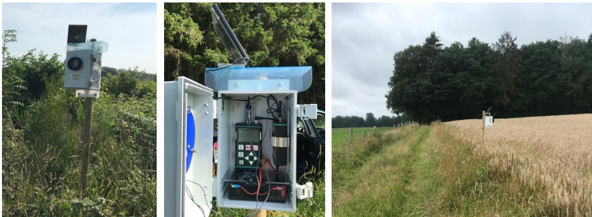
Abbildung 1: Beispiel einer Messapparatur für eine Langzeitmessung (batcorder-System der Fa. ecoObs, Erlangen). Die wetterfeste Box wird an einem Holzstab befestigt und kann so auch im Offenland errichtet und betrieben werden. Ein Solarpanel lädt zudem die Batterie auf.
